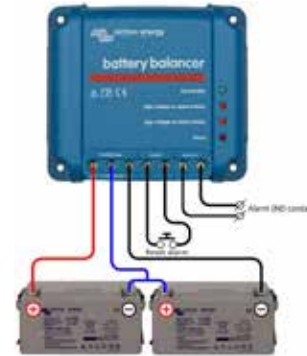
Battery Balancer (BMS012201000) Der Battery Balancer (Ladungszustandsausgleicher) gleicht den Ladezustand von zwei in Serie geschalteten 12 V Batterien oder von mehreren parallele Strängen von in Serie geschalteten Batterien aus. Wenn die Ladespannung eines 24 V-Batteriesystems auf über 27 V ansteigt, schaltet sich der Battery Balancer ein und vergleicht die Spannung bei den zwei in Serie geschalteten Batterien. Der Battery Balancer entnimmt der Batterie (oder den parallel geschalteten Batterien) mit der höchsten Spannung einen Strom von bis zu 1 A. Der daraus resultierende Unterschied beim Ladestrom sorgt dann dafür, dass sich alle Batterien an denselben Ladezustand angleichen. Falls notwendig können mehrere Balancer parallel geschaltet werden. Eine 48 V Batterie-Bank kann mit drei Battery Balancers ausgeglichen werden.
