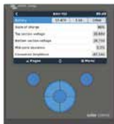
Color Control Der leistungsstarke Linux-Computer, versteckt hinter dem Farbdisplay und Tasten, sammelt Daten von allen Victron-Geräten und zeigt sie auf dem Display an. Abgesehen von dem Datenaustausch mit den Victron-Geräten kommuniziert das Color Control außerdem über NMEA2000, Ethernet und USB.
